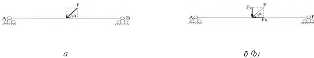
Рис. 4. Схема навантаження гвинта / Fig. 4. Screw loading scheme
