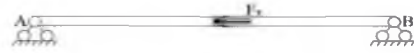
Рис. 9. Схема навантаження гвинта за осьового розтягу – стиску / Fig. 9. Screw loading scheme for axial tension-compression
