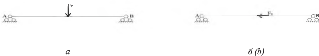
Рис. 5. Розкладання навантаження на компоненти / Fig. 5. Decomposition of the load on the components
