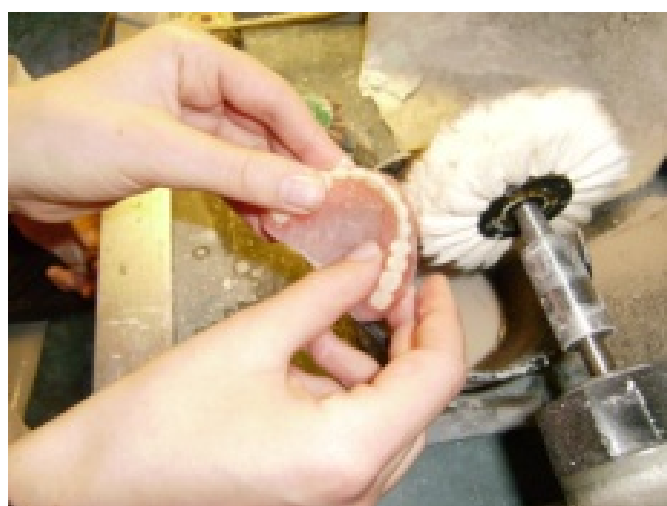
Рисунок 55. Полировка протезов жесткой круглой волосяной щеткой
