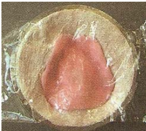
Рисунок 44. Заполнение кюветы пластмассовым тестом при методе компрессионного прессования
