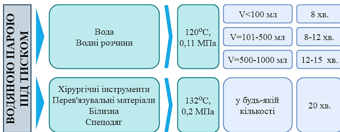
Рис. 8.11. Основні параметри стерилізації водяною парою під тиском
