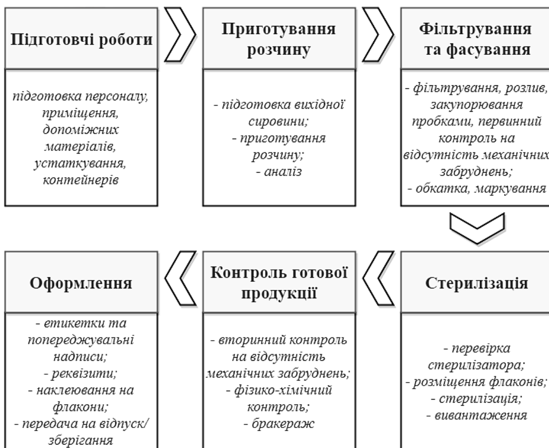
Рис. 8.9. Схема приготування парентеральних розчинів
