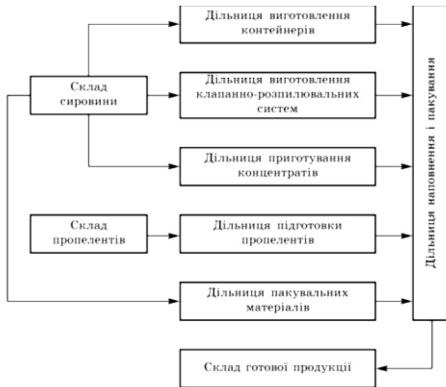
Рис. 7.2. Схема технологічного процесу виробництва фармацевтичних аерозолей.
