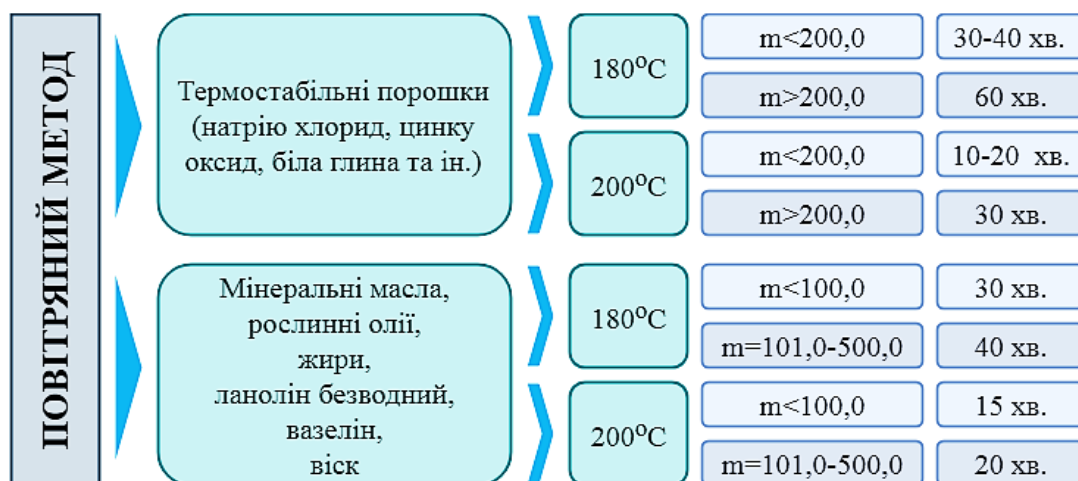
Рис. 8.10 Основні параметри повітряної стерилізації
