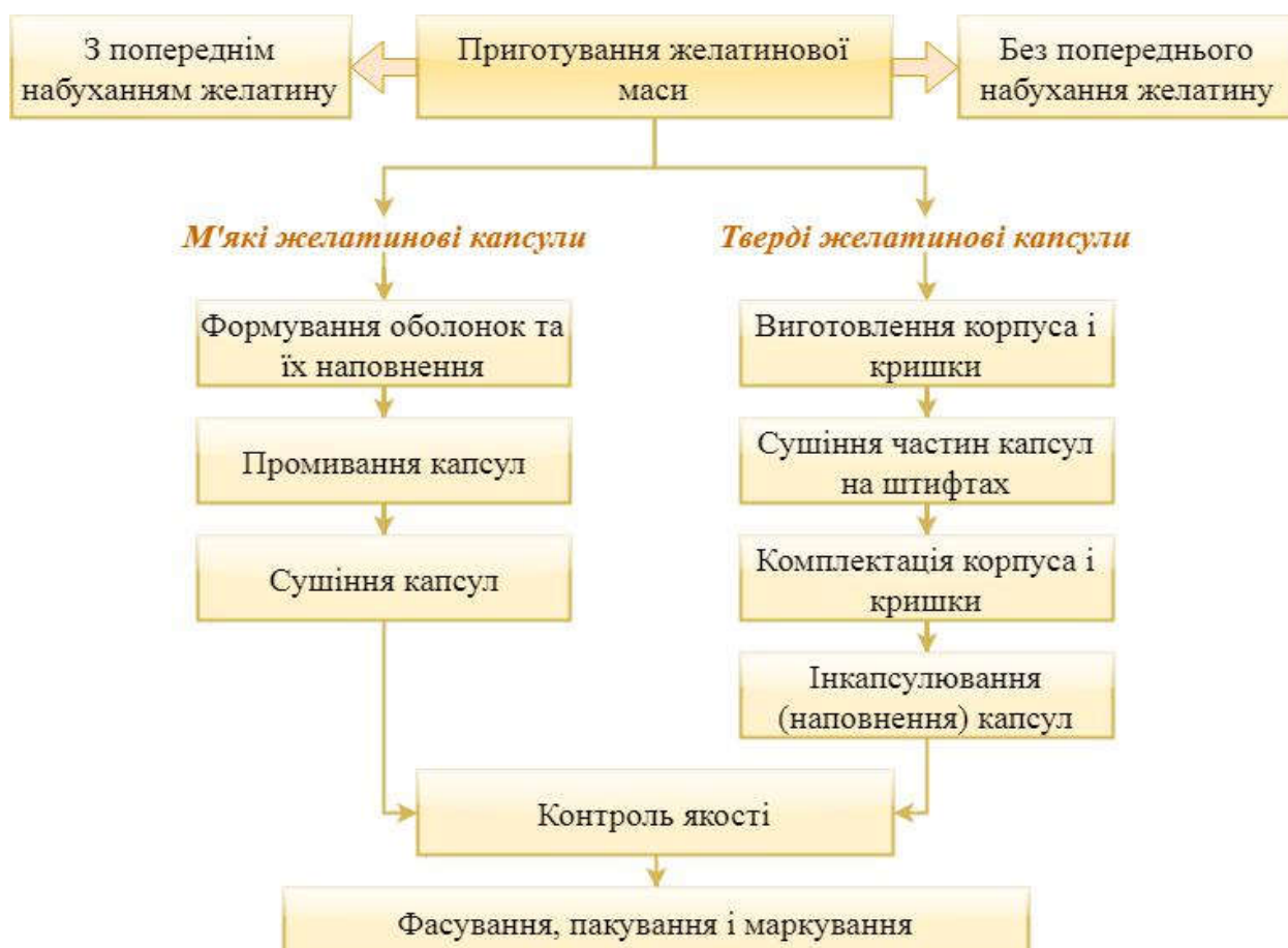
Рис. 9. Схема технологічного процесу отримання желатинових капсул
