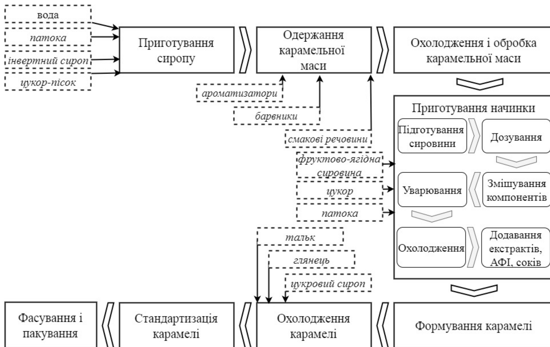
Рис. 17. Принципова технологічна схема отримання карамелі
