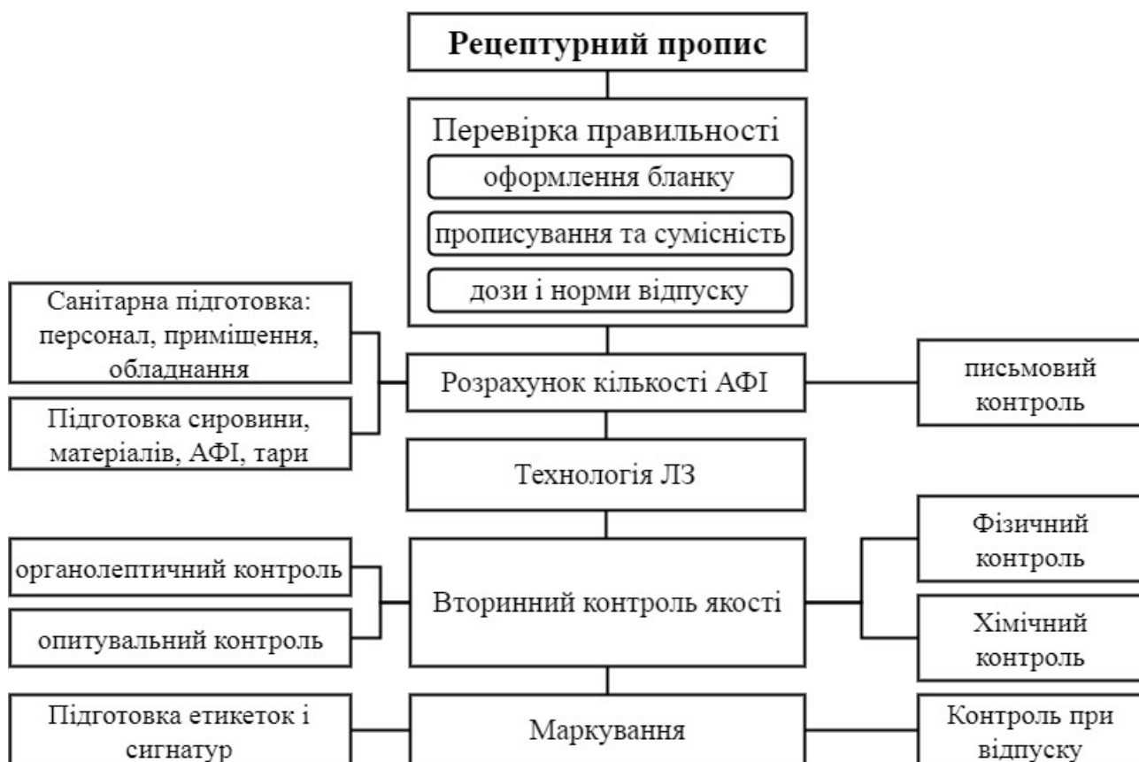
Рис. 2. Принципова схема виготовлення стерильних та асептично виготовлених лікарських засобів в умовах аптеки
