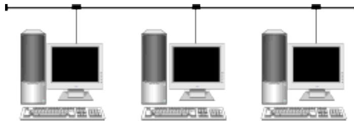
Рис. 2. Фізична топологія «Шина»
