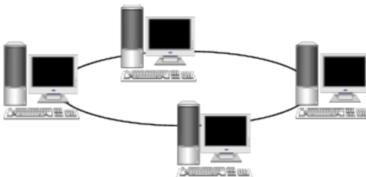
Рис. 3. Фізична топологія «Кільце»
