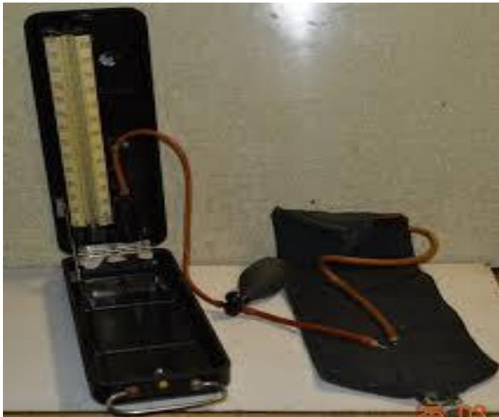
Рисунок 1. Ртутный тонометр.
