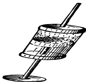
Мал. 9. Шприц Жане для визначення концентрації \text{CO}_2 за Д.В.Прохоровим.
