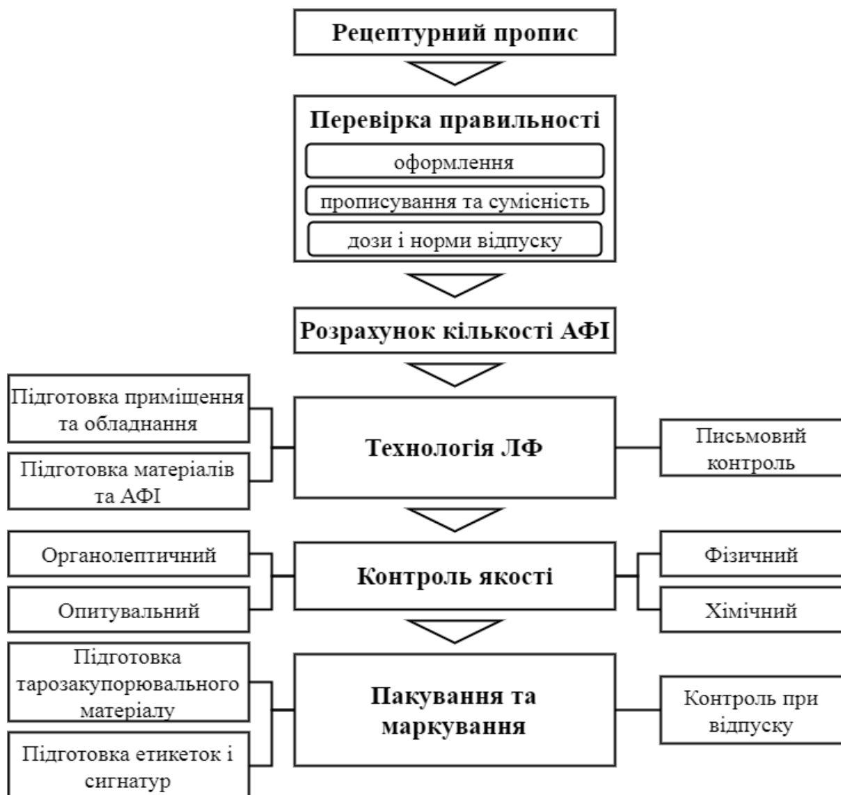
Рис. 2. Принципова схема виготовлення екстемпоральних лікарських засобів
