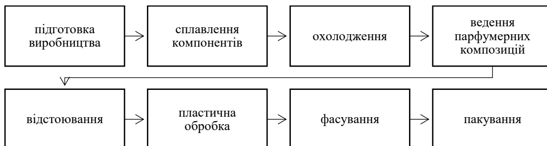
Рис. 3.7. Технологічний процес готування жирових кремів [джерело: власна розробка]
