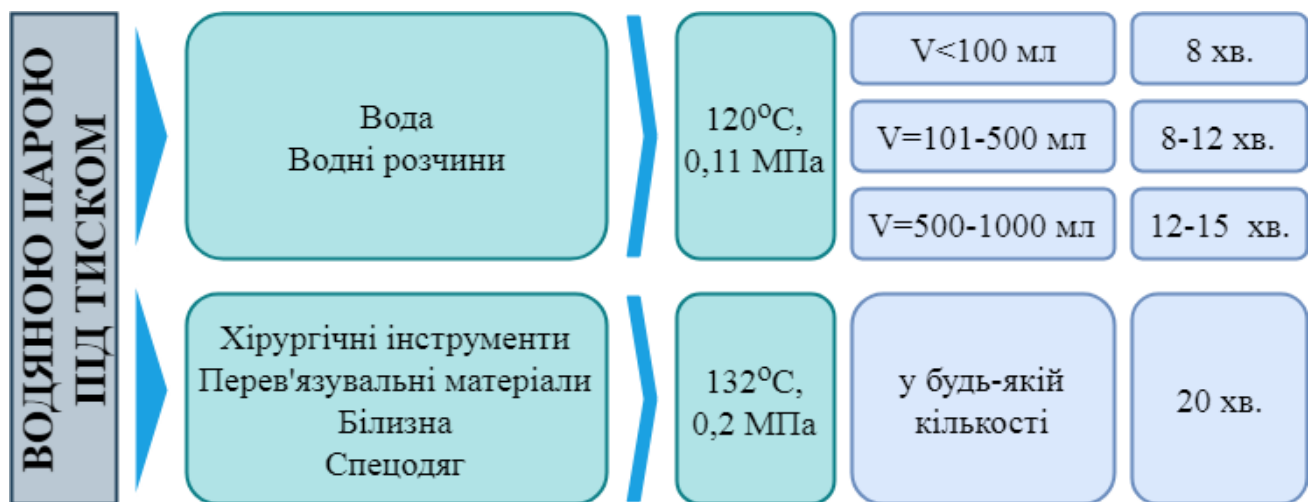
Рис. 4.8. Основні параметри стерилізації водяною парою під тиском [джерело: власна розробка]
