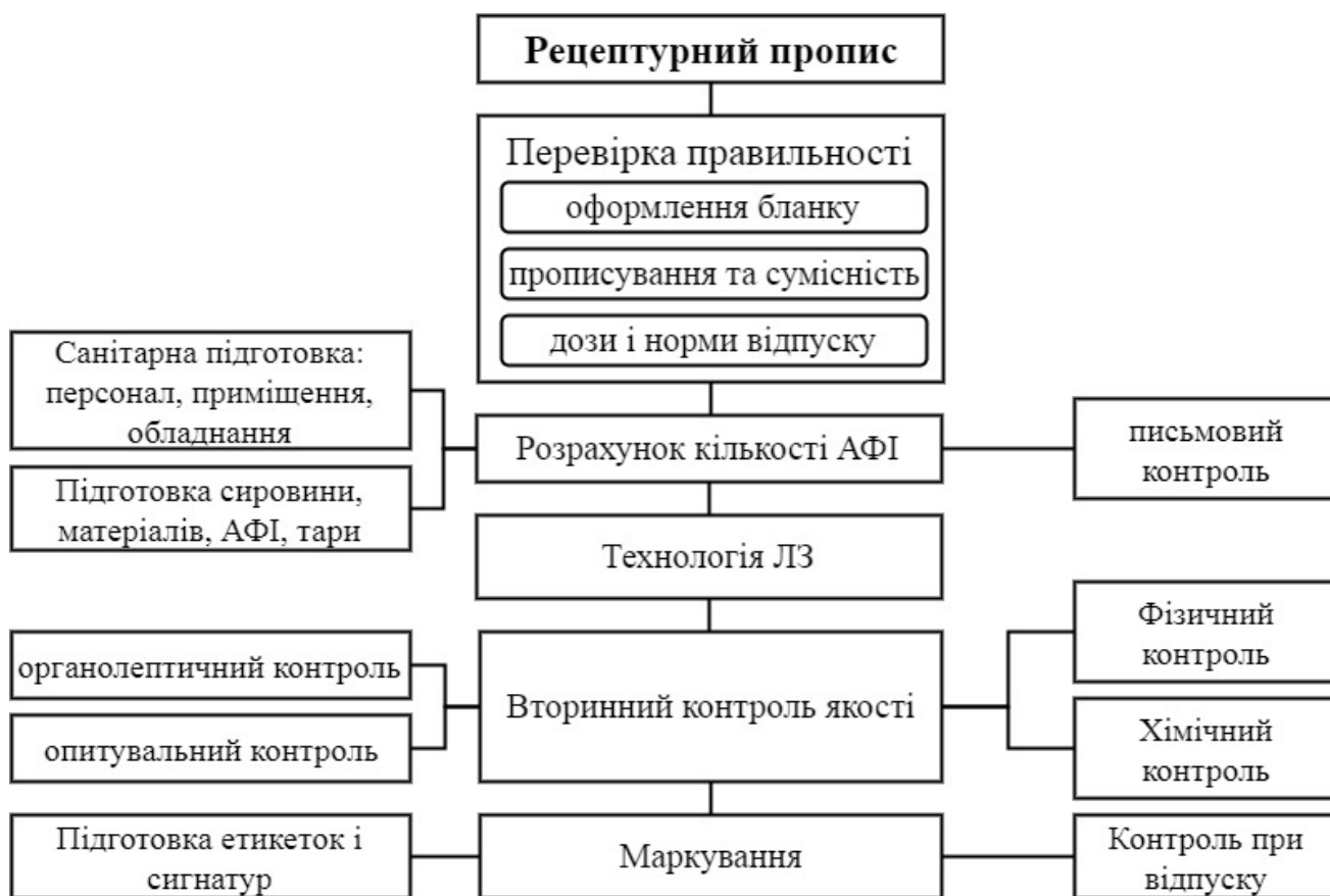
Рис. 4.2. Принципова схема виготовлення стерильних та асептично виготовлених лікарських засобів в умовах аптеки [джерело: 2]
