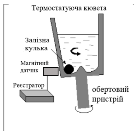
Мал. 12. Принцип роботи механічного коагулометра. Кювета з плазмою розташована під нахилом і обертається, кулька стоїть на місці, не обертається. У момент згортання кулька захоплюється згустком, як тільки кулька йде від датчика змінюється магнітне поле, прилад реєструє момент згортання плазми
