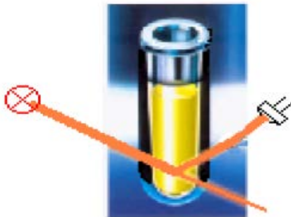
Мал. 15. Нефелометричний принцип вимірювання світлорозсіювання. Метод дозволяє підвищити точність вимірювань та відтворюваність до 2-3%, а також знизити вплив на результат самого зразка
