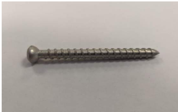
Рис. 5.1. Блокований гвинт з біодеградуючого магнієвого сплаву МС-10.
