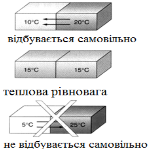
Рис. 1.3 Передача теплоти згідно з другим законом термодинаміки
