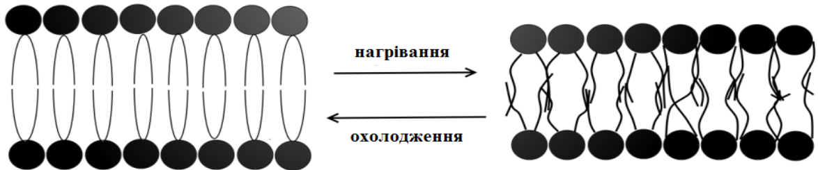
Рис. 3.4 Вплив температури на структуру мембрани
