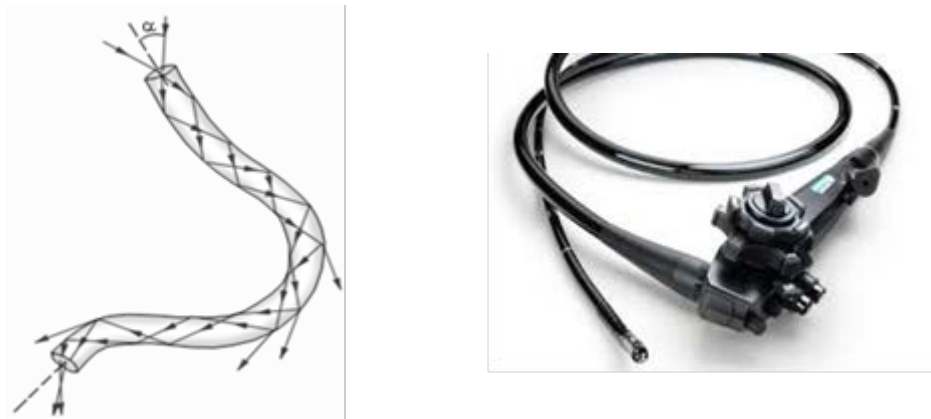
Рис. 14.3 Повне внутрішнє відбивання в скляному волокні. Ендоскоп
