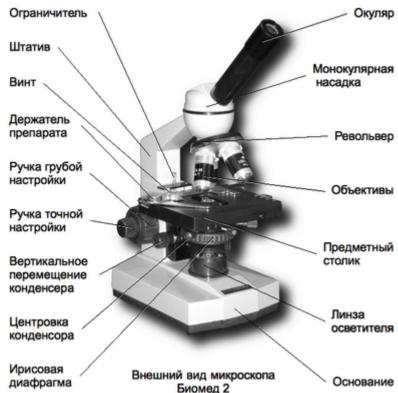
Принципиальная схема оптической части микроскопа состоит из двух систем линз. Одна из них расположена в окуляре, т.е. устройстве для глаз
