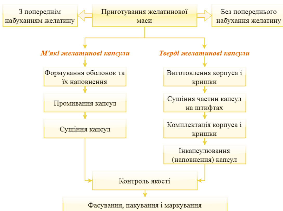
Рис. 2.9. Схема технологічного процесу отримання желатинових капсул [джерело: 8]
