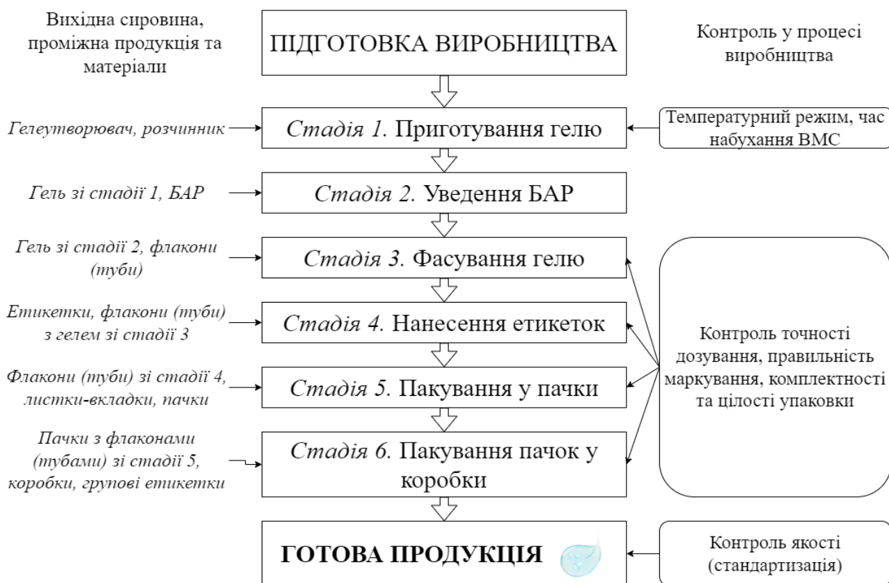
Рис. 4.9. Технологічна схема промислового виробництва гелів [джерело: 27]
