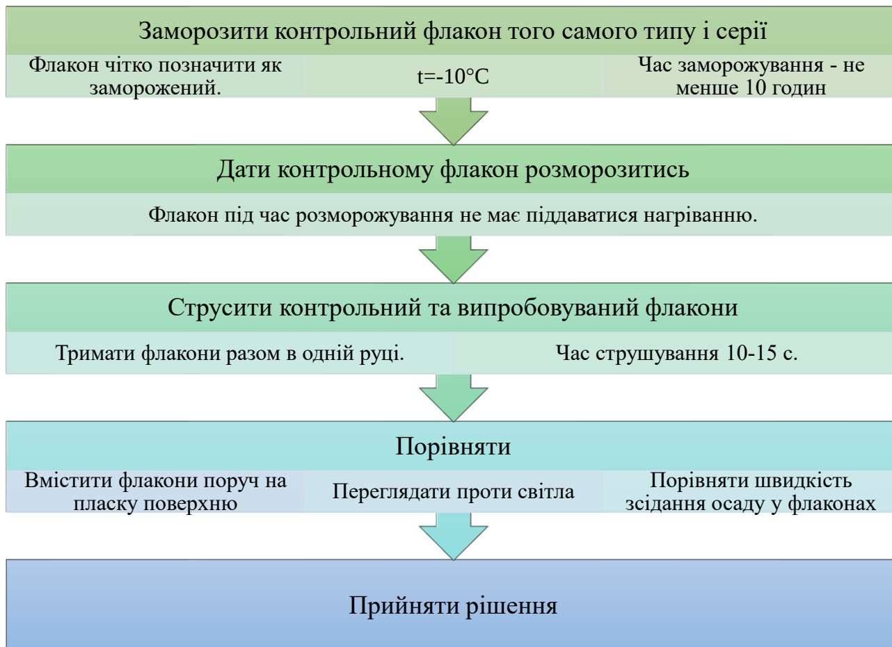
Рис. 2.11. Алгоритм проведення тесту на струшування [джерело: власна розробка на основі 48 ]
