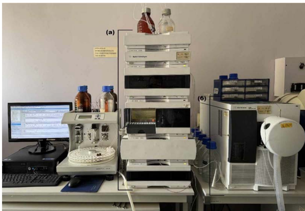
Примітки: а – ВЕРХ Agilent 1260 Infinity, б – МС детектор Agilent 6120. Рисунок 2.1 – Високоєфективний рідинний хроматограф Agilent 1260 Infinity з одноквадрупольним мас-спектрометричним детектором з електроспрей-іонізацією Agilent 6120.
