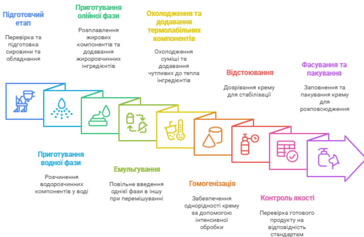
Рис. 3.2. Технологічна схема виробництва емульсійних кремів [джерело: власна розробка з використанням https://app.napkin.ai/ ]
