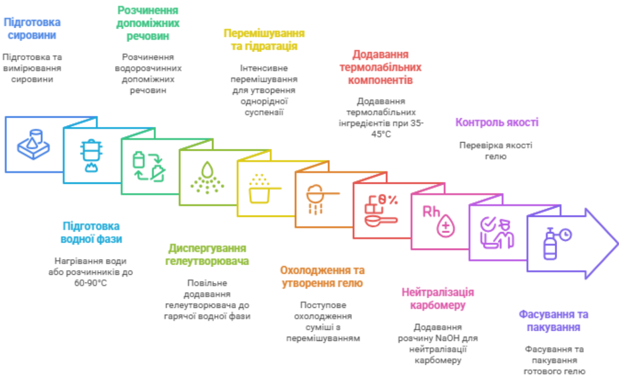
Рис. 3.3. Технологічна схема виробництва гелів [джерело: власна розробка з використанням https://app.napkin.ai/ ]
