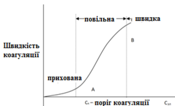
Рис. 9.16 Залежність швидкості коагуляції від концентрацій електролітів
