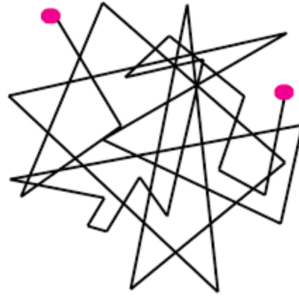
Рис. 9.4 Схема переміщення частки при тепловому русі
