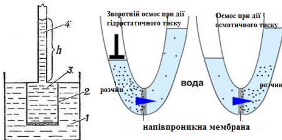
Рис. 9.6 Схема осмометра: 1 – вода; 2 – розчин; 3 – напівпроникна мембрана
