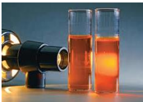
Рис. 9.10 Спостереження конуса Тіндаля
